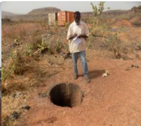
Piezomètre asséché dans le site
